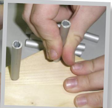
5. Sechs 8 cm lange Aluminiumdrähte mit dem Seitenschneider ablängen. Anschließend Grate schleifen.
