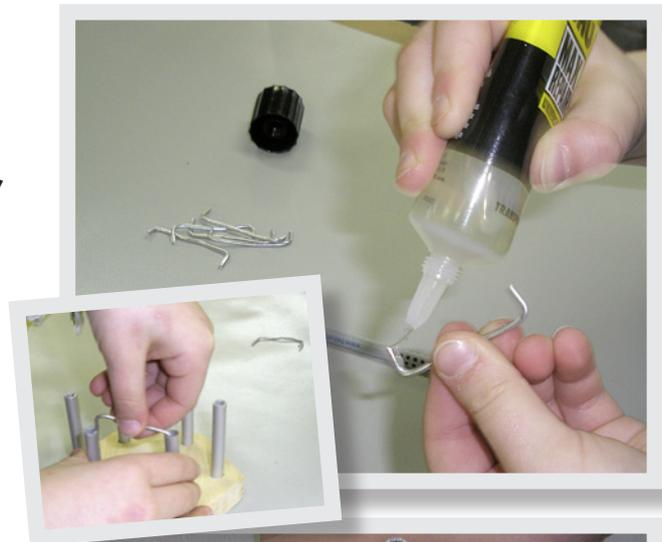
✓ *Vergewissern Sie sich, dass die zu klebenden Oberflächen sauber, trocken, staub- und fettfrei sind. Tragen Sie den Klebstoff auf einer Seite auf. Drücken Sie die Teile gegeneinander. Während der nächsten 15 Minuten können Korrekturen durchgeführt werden. Die maximale Endfestigkeit wird nach ca. 24 Stunden erreicht.*
